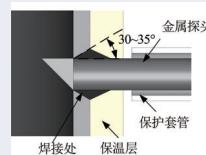
推荐安装位置为过热器和再热器出口、调温喷雾与蒸汽轮机之间上下游比例约为9:1直管段，并远离调温喷雾以避免探头接触到水滴导致干扰。根据用户需要，可增加安装测点到其它蒸汽管道、水管道(水中颗粒监测)。
